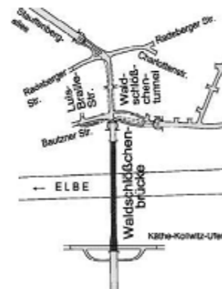
Der Tunnel unter der Waldschlößchenstraße wird für eine kreuzungsfreie Zufahrt zur neuen Brücke sorgen.
