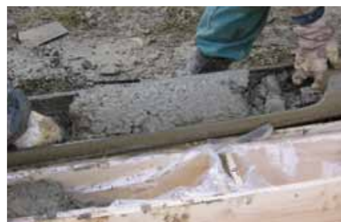
Ungestörte Proben wurden aus Rammschappen mit Entnahmefenster (rechts) und als Gefrierkern (links) entnommen.
