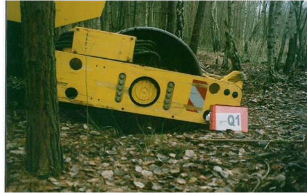
Bild 7: Beispiel für ein eingesacktes Versuchsgerät während eines Versuches.
